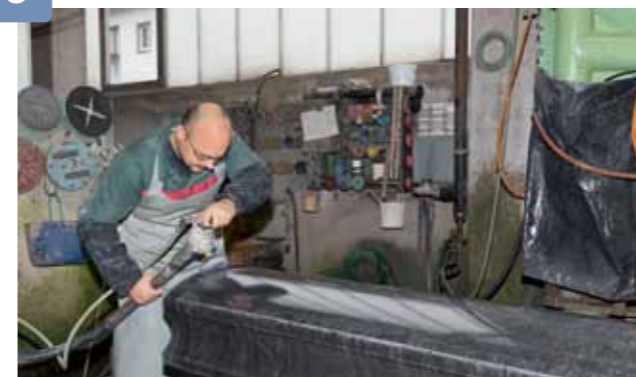
Ein erfahrener Handschleifer poliert ein bombiertes Grabmal aus Schwarz-Schwedisch.
