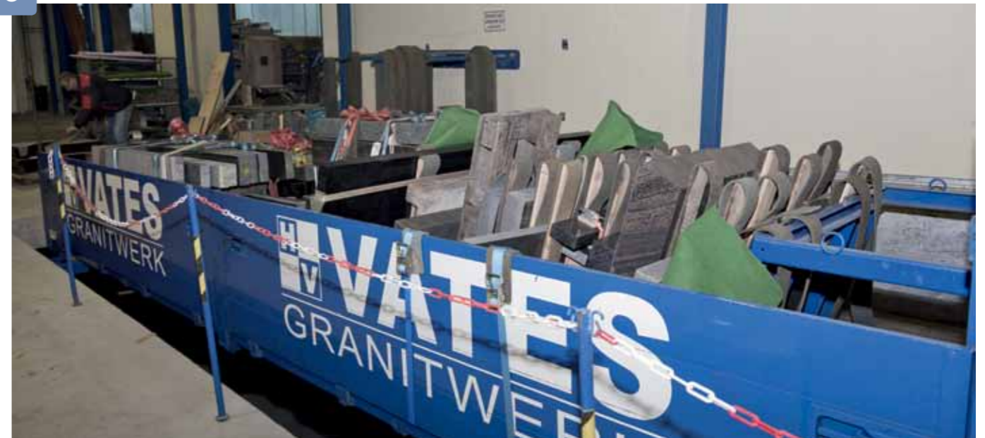
Kommissionen werden schräg stehend aufgeladen, damit auch Kunden ohne Außenkran bedient werden können.
