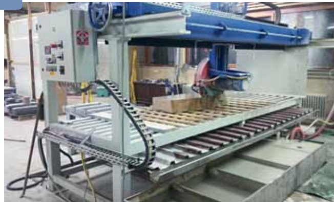
Die Säge arbeitet mit einer autarken Wasseraufbereitung unabhängig vom Leitungsnetz.
