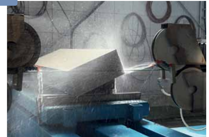
Die Seilsägetechnik erlaubt eine flexible Produktion von Formen und Konturen ab der Tranche.
