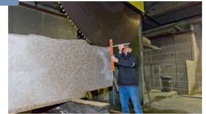
Das 3-m-Blatt der Kreissäge wird auf den Waldstein-Granit eingerichtet.
