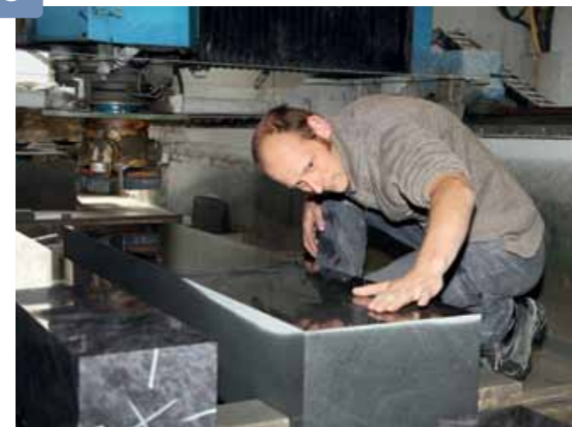
Christian Schörner prüft die Politur eines Sockels: Eigenfertigung rechnet sich nur mit Qualitätswerkzeugen.
